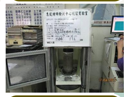
混凝土試體抗壓
