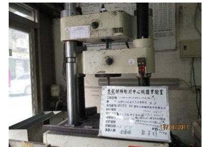
鋼筋拉伸試驗
