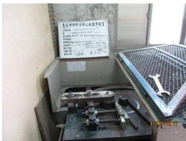
鋼筋抗彎試驗
