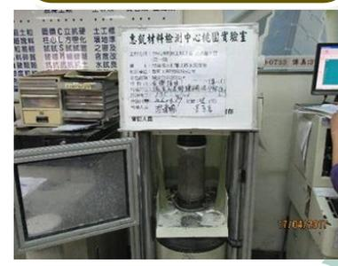
混凝土試體抗壓
