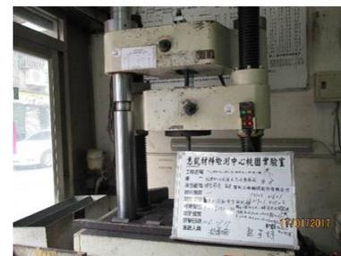
鋼筋拉伸試驗
