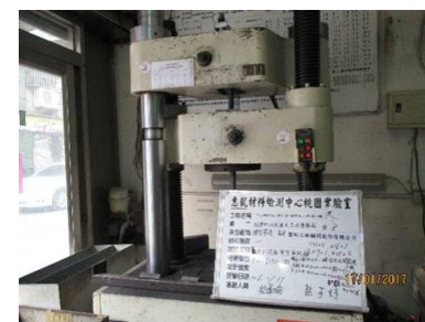
鋼筋拉伸試驗
