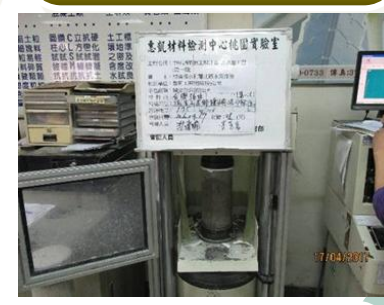
混凝土試體抗壓
