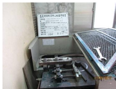
鋼筋抗彎試驗
