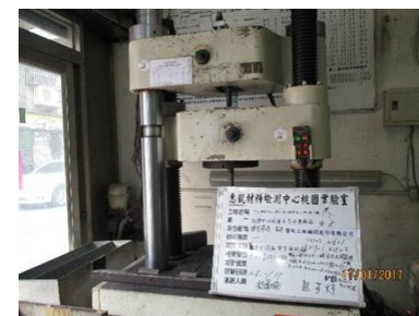
鋼筋拉伸試驗
